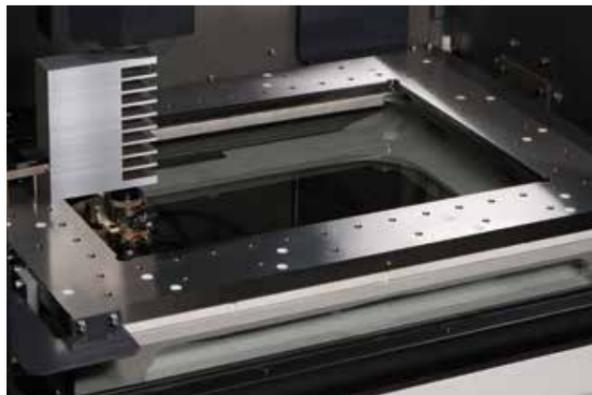
Der Vier-Seiten-Rahmentisch widersteht dem Dielektrikum und Erodierabtrag über Jahrzehnte. Hochwertige Edelstahlkomponenten und der Edelstahlarbeitstank sorgen für Zuverlässigkeit und Wartungsfreiheit.
