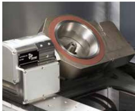
Zur Bearbeitung von Koniken mit höchsten Genauigkeitsanforderungen: die in die Maschinen-Steuerung integrierte Dreh-/Schwenkachse. Mehrachsige Bearbeitung bis ins Zentrum des Werkstückes und Mehrseitenbearbeitung in einer Aufspannung, Realisierung von hochgenauen konischen Polygonen.
