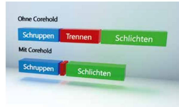
Beim Schruppen trennt die Erodiermaschine das Gut vom Abfallteil, verbindet nach dem Schnitt aber beide Teile über einen oder mehrere kleine Schweißpunkte wieder miteinander. Anschließend können die Abfall-teile aus dem Werkstück entfernt und eingesammelt werden. Danach kann das Bearbeitungsprogramm weiterlaufen. Besonders bei Langläufern mit vielen Aussparungen reduziert sich die Maschinenlaufzeit dadurch deutlich.
