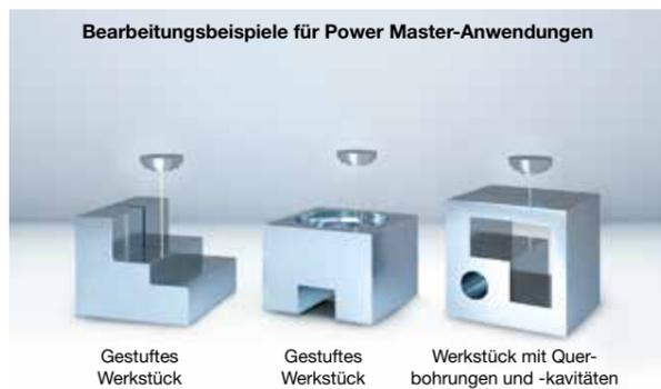
Der Power Master Control bietet ein Höchstmaß an Prozessstabilität – unabhängig von der zu schneidenden Form. Abgestufte Werkstückformen, Bohrungen oder andere Hürden für einen stabilen Schneidprozess werden sofort erkannt und die Steuerung übernimmt Schneid- und Spülparameter für einen sicheren Prozess und beste Genauigkeit.
