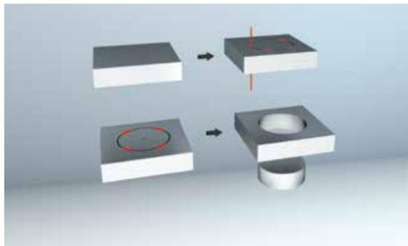
Im Schruppschnitt wird technologisch steuerbar eine Haltebrücke zum Ausfallteil gelegt – so fällt es nicht. Auf diese Weise können viele Durchbrüche vorge-schruppt werden und nach Entfernung der Ausfallteile die Nachschnitte erfolgen. Vollautomatisch und mann-los – über Nacht oder am Wochenende. Weniger Kosten, mehr Profit.
