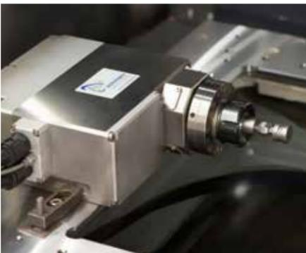
Eine voll in die Maschinen-Steuerung integrierte, servogesteuerte B-Achse ermöglicht Ihnen das Drahterodieren am rotierend mitgeführten Werkstück. Hiermit lassen sich Teilungs- und Mehrseitenbearbeitungen in einer Aufspannung sowie Simultanbearbeitungen durchführen.
