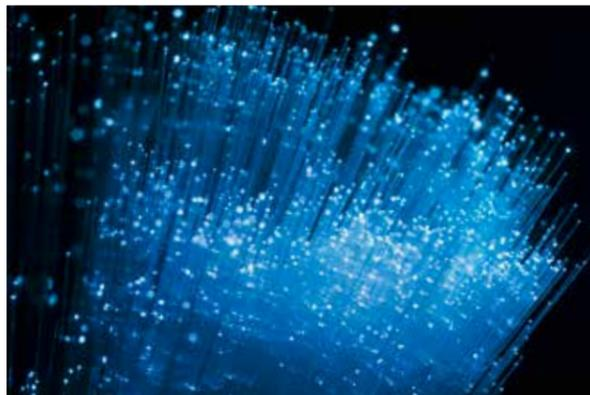
Die Mitsubishi Electric Polymer-Lichtwellenleiter besitzen entscheidende Vorteile – nicht nur gegenüber herkömmlichen Kupferleitungen, sondern auch gegenüber Glasfasern. Die hohen Übertragungsraten bei geringstem Platzverbrauch und maximaler Biegsamkeit sind neben der völligen Wasserresistenz entscheidende Kriterien für fortschrittlichste Erodiermaschinen. Das einzige, was Sie als Anwender davon merken, sind die gesteigerte Langlebigkeit und der Präzisionsgewinn.
