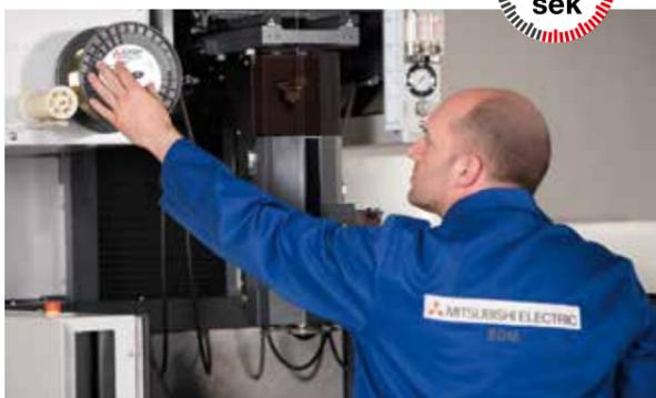
Die Rolle einfach austauschen und den Erodierdraht über die Transportrollen führen – alles wieder arbeitsbereit in 92 Sekunden.
