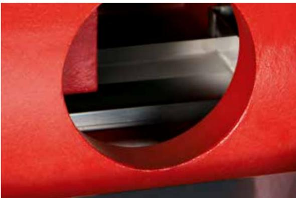
Der speziell ausgewählte Meehanite-Gusswerkstoff sichert eine Langlebigkeit, die in Jahrzehnten gemessen werden kann und hohe Werkstückgewichte Tag für Tag verkraftet. Selbst stärkste Beanspruchung steckt das solide Maschinenbett einfach weg – anders als manch deutlich günstigerer Werkstoff.
