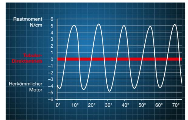
Kennen Sie das Gefühl, wenn Sie einen Elektromotor drehen, der immer ein Rastmoment findet? Genau dieses Rastmoment ist jedoch unerwünscht, genauso wie Drehmomentschwankungen. Der Tubular-Direktantrieb ist somit der optimale Antrieb für Präzisionsanwendungen wie die Funkenerosion.
