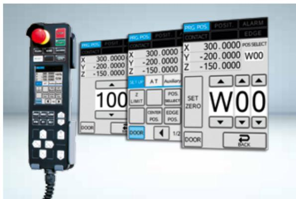
Die ergonomisch gestaltete, intelligente Handbedienbox vereint alle relevanten Funktionen für den Regel- und Einrichtbetrieb in einer Einheit. Das integrierte LCD-Display lässt sich durch den Bediener individuell konfigurieren. Tasten zum Verfahren aller acht möglichen CNC-Achsen inklusive.
