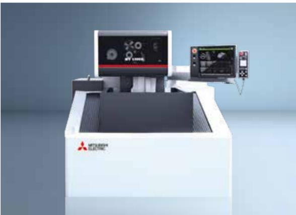
Einrichtbetrieb, Programmierung, Wartung, etc. – alle wesentlichen Elemente sind an der Maschinenfront direkt erreichbar. Der komplette Drahtlauf, automatische Drahtzuführung, Drahtführungsköpfe wie auch der gesamte Arbeitsbereich sind sehr gut zugänglich – nicht zuletzt begünstigt durch die offene Bauweise und die automatische Vertikalschiebetür.
