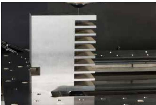
Ein zeitraubendes Zurückfahren zur Ausgangsposition entfällt, stattdessen geht es direkt weiter – dank der hochentwickelten thermischen Drahtaufbereitung. Je nach Bearbeitungsbedingung kann das Einfädeln mit oder ohne Wasserstrahlführung und auch im Dielektrikumbad zuverlässig erfolgen – je nach Höhe des Werkstücks.
