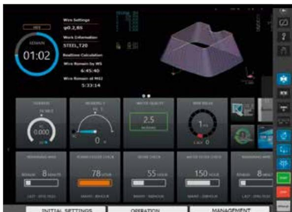
Die leicht verständliche Darstellung aller wesentlichen Bearbeitungsparameter in konfigurierbarer Form hilft, jederzeit die Kontrolle zu behalten. Auf einen Blick sind – wenn gewünscht – Bearbeitungsstatus, Zeitabläufe, Wartungszustand und weitere Informationen klar sichtbar. Die Konfiguration erfolgt in einfachster Art und Weise.
