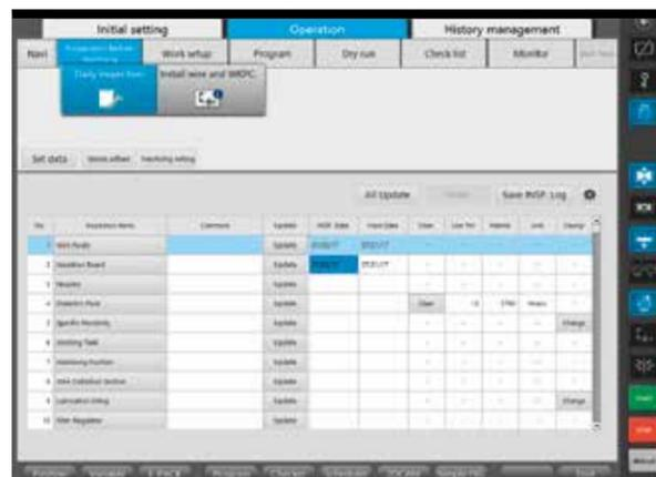
Bei der Vorbereitung anstehender Bearbeitungsaufgaben unterstützen Übersichten zu Restverfügbarkeit von Erodierdraht, zum Zustand von Filterpatronen und Deionisierharz sowie zu weiteren Parametern. So lassen sich Stillstandszeiten durch endliche Verbrauchsmaterialien oder Verschleißteile verhindern und die Laufzeiten der Maschinen optimieren.
