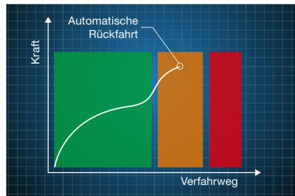
Die Drahterodiermaschinen von Mitsubishi Electric überprüfen ständig die auftretenden Achskräfte und erkennen somit vollautomatisch einen potentiellen Unfall, bevor er passiert. Wenn sich ein Hindernis auf dem Verfahrweg befindet, wird dieses beim Anfahren elektronisch durch Lastveränderung des Antriebs erkannt und die Steuerung sorgt umgehend für einen sicheren Rückzug. Sicher ist sicher!
