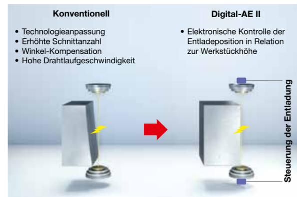
Durch genaue Kontrolle der Entladungsposition wird nur dort abgetragen, wo es notwendig ist. Die patentierte Funktion des Digital-AE II verschafft Ihnen Vorteile bei Schrupp-, Schlicht- und Feinschlichtbearbeitung – sowohl hinsichtlich der Präzision als auch der Bearbeitungszeit.
