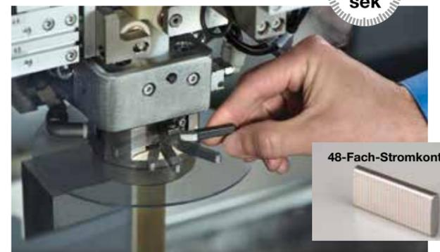
Den Stromkontakt nur mit der Hand und einem kleinen Messhelfer wechseln – in einer Geschwindigkeit fit für die Formel 1.
