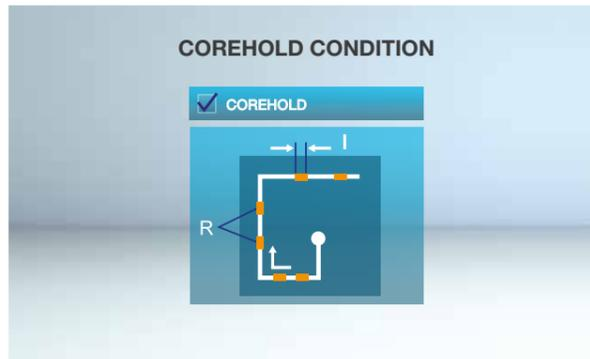
Platten mit vielen herauszuschneidenden Formen erfor-derten bisher die Anwesenheit des Werkzeugbauers über mehrere Stunden. Die Form musste bis auf einen kleinen Steg aus dem Werkstück gearbeitet werden. Der Werkzeugbauer drückte dann den Steg heraus und nahm das Metallteil aus dem Becken. Mit den Ma-schinen von Mitsubishi Electric können solche Ar-beiten auch als Langläufer über Nacht oder übers Wochen-ende bearbeitet werden, ohne dass manuell eingegrif-fen werden muss.
