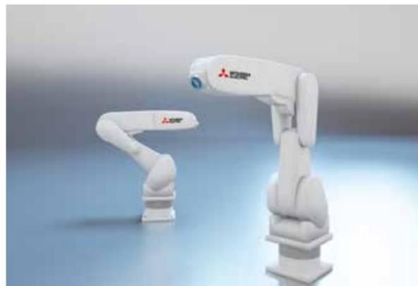
Flexible Lösung: Knickarm-Roboter bis 15 kg in Mitsubishi Electric Qualität.
