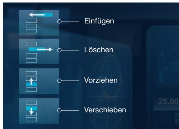
Neue Jobs können auf einfache Weise während der Bearbeitung hinzugefügt oder die Reihenfolge anstehender Bearbeitungen verändert werden. Die neue Jobverwaltung mit Prioritäten-Management ermöglicht die Veränderung einer Bearbeitungsliste ohne Unterbrechung der Bearbeitung.
