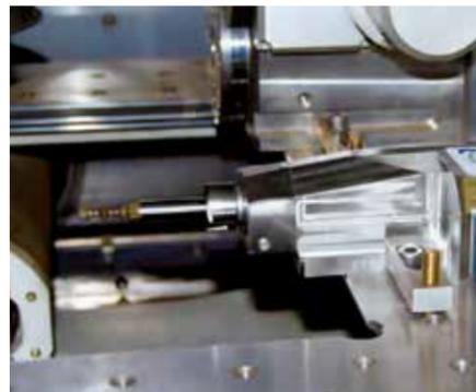
Voll in die Maschinen-Steuerung integrierte Rotierspindel mit Positionierung für kleinste hochgenaue Bauteile, z. B.: Herstellung von Auswerferstiften mit Durchmesser  $\geq 0,05$  mm, Realisierung konischer Gewinde in der Medizintechnik, erosives Schleifen und Drehen, Simultanbearbeitung.
