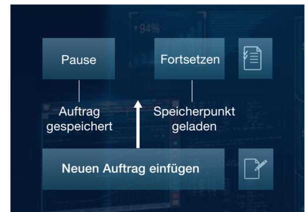
Selbst eine laufende Bearbeitung kann einfach unterbrochen werden, wenn eilige Aufträge bearbeitet werden müssen. Die Steuerung speichert den aktuellen Stand der Bearbeitung. Nach Erledigung eines eingeschobenen Auftrages kann an der Unterbrechungsstelle wieder eingestiegen und die Bearbeitung umgehend fortgesetzt werden – Flexibilität auf Knopfdruck ohne Programmieraufwand.
