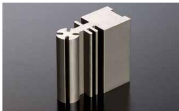
Vier Schnitte mit Ra 0,28 µm im Vergleich zu konventioneller Maschine.
