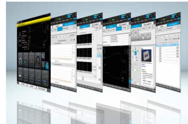
Il dialogo interattivo permette agli utenti con meno esperienza di essere guidati passo dopo passo attraverso l'intero processo di lavorazione, dalla programmazione all'avvio del taglio. Le liste di controllo sono importanti per rivedere le impostazioni relative alla lavorazione mentre gli indicatori permettono di identificare lo stato della macchina con un semplice colpo d'occhio.
