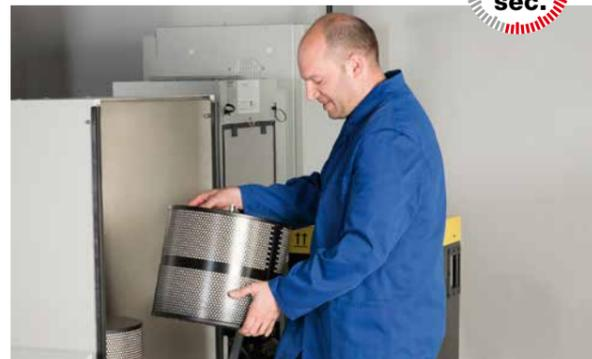
... senza bisogno di attrezzi e senza perdite di tempo. Due mani e 32 secondi – e il filtro è sostituito.
