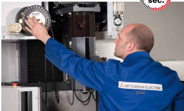
Basta sostituire la bobina e far passare il filo di erosione sopra i rulli guida. Tutto pronto a rientrare in funzione in 92 secondi.
