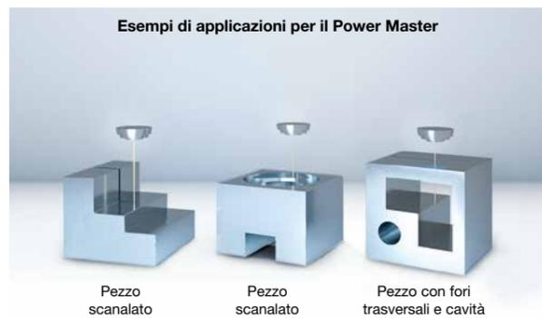
Il controllo Power Master è pensato per donare il livello più elevato di stabilità nei processi, a prescindere dalla forma che deve essere tagliata. Le forme scanalate, i fori complessi e tutti gli altri tipi di ostacoli vengono identificati appena possibile ed il controllo adatta automaticamente i parametri di taglio per un processo di lavorazione più sicuro e preciso.
