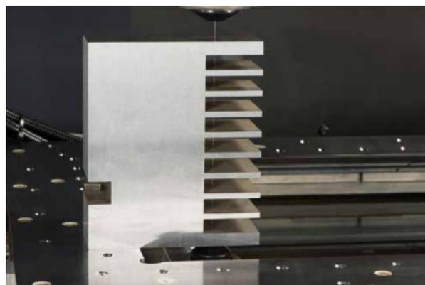
Basta perdere tempo tornando ogni volta al punto d'inizio! La macchina è ora in grado di riprendere dove era stata interrotta, grazie all'avanzato sistema di infilaggio automatico. A seconda delle condizioni di lavorazione, l'infilaggio può essere effettuato con o senza l'ausilio del getto d'acqua e persino in immersione, a seconda dello spessore del pezzo.
