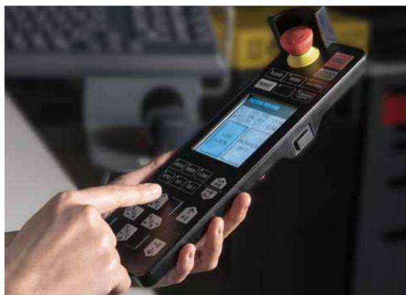
Semplici operazioni di allineamento con il dispositivo di comando manuale, in dotazione standard di Mitsubishi Electric. Tutte le funzioni di comando essenziali a portata di mano, là dove servono.
