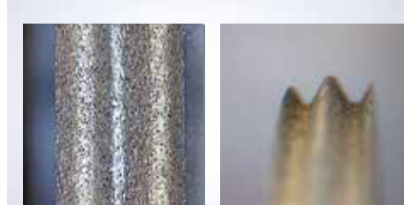
Metallisch gebundene D46-Diamant-Schleifscheibe, Mehrfachprofil D = 150 mm, Innen- und Außenradius r = 0,12 mm \pm 30^\circ
