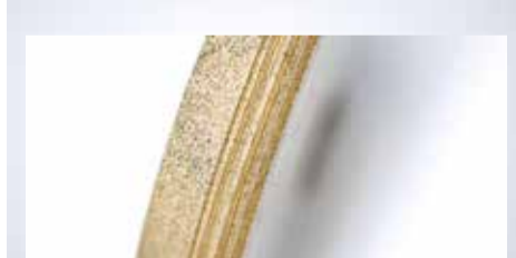
Metallisch gebundene CBN-Schleifscheibe B25/V240, spitz zulaufende Geometrie mit 60^\circ -Winkel umlaufend exakt hergestellt
