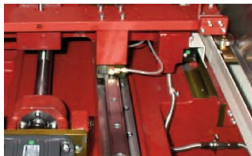
Die FA-S Advance ist **standardmäßig** mit **Glasmaßstäben** in X- und Y-Achse ausgestattet. Die ideale Anordnung in unmittelbarer Nähe zum Arbeitsbereich ermöglicht höchste Präzision.
