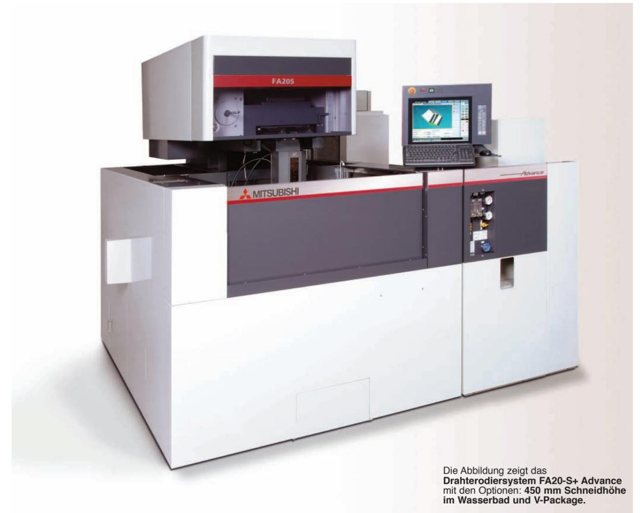
Die Abbildung zeigt das Drahterodiersystem FA20-S+ Advance mit den Optionen: 450 mm Schneidhöhe im Wasserbad und V-Package.
