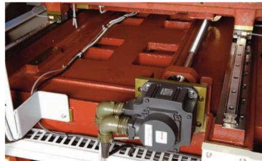
**Direktantrieb und großzügig dimensionierte Spindeln.**
