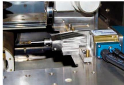
**Rotationsachse (B-Achse) ITS-HV-100**
