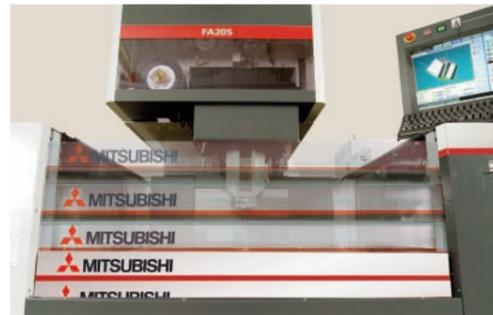
Die Vertikalschiebetür öffnet und schließt auf Knopfdruck (außer FA10-S Advance). Diese Lösung gewährleistet größtmögliche Platzeinsparung und beste Zugänglichkeit des Arbeitsbereiches.
