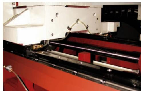
Die klassische **Stahlguss-Maschinenkonstruktion** ist der Garant für Langlebigkeit und ein solides Maschinenbett. Hohe Werkstückgewichte werden so mit Leichtigkeit aufgenommen.
