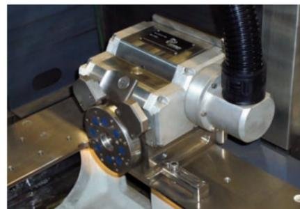
**Rotationsachse (B-Achse) ITS-HV-100**
