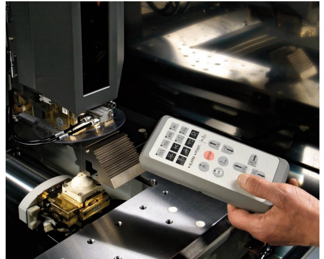
Das Automatic Threading System (AT) fädelt den Draht in nur 10 Sekunden ein und ist standardmäßig kombiniert mit einem Drahthäcksler. Schneller, sicherer und komfortabler geht es nicht.
