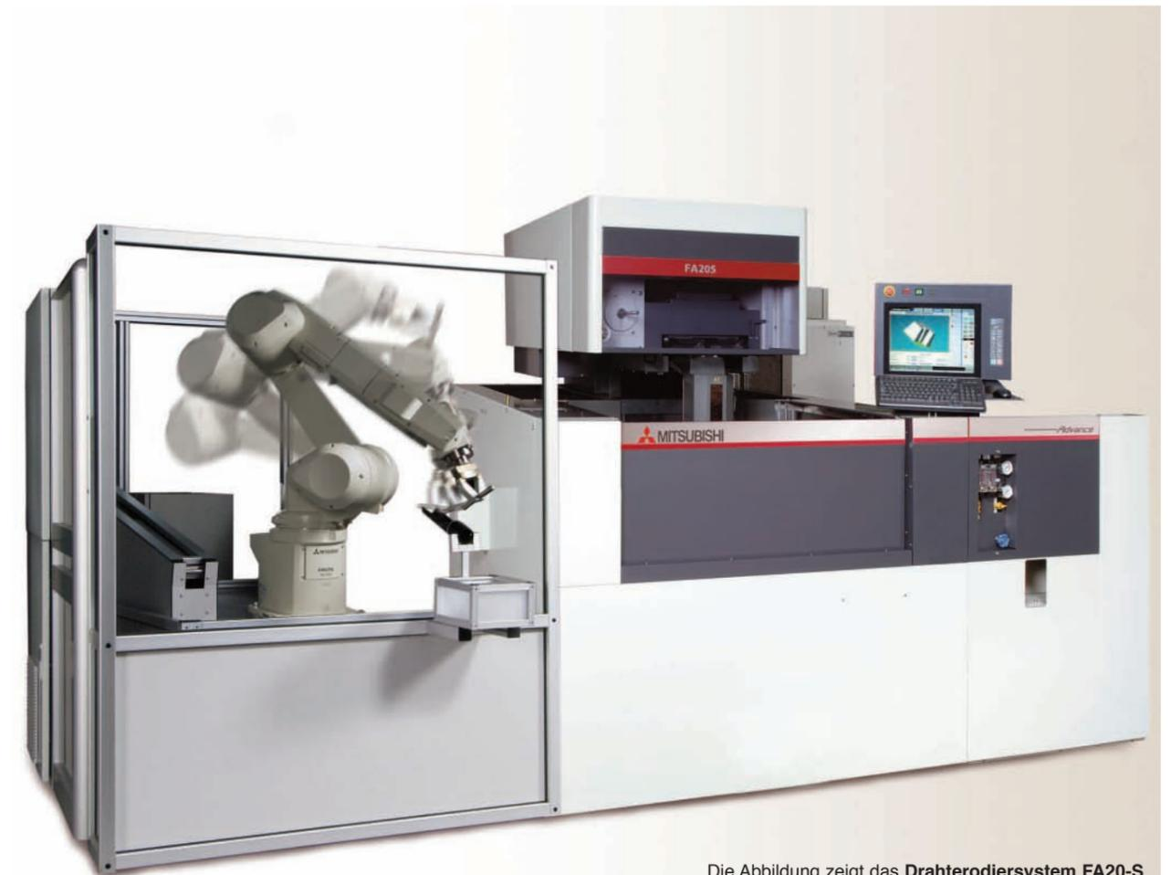
Die Abbildung zeigt das **Drahterodiersystem FA20-S Advance**, automatisiert mit dem **Mitsubishi Roboter RV-12SL**.
