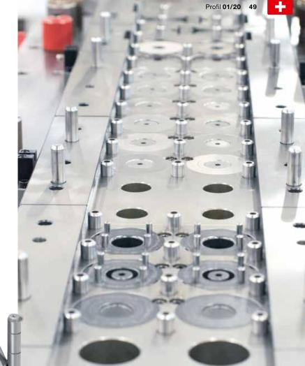
Folgerichtig: Komplexe Werkstücke werden auf mehrstufigen Umformwerkzeugen in einem Ablauf produziert.
