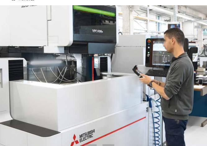
Begreiflich: die Steuerung mit großem Touchscreen und Bedienoberfläche – vergleichbar mit aktuellen Smartphones Dafür hat die MP2400 Connect unschlagbare Vorteile. Sie arbeitet äußerst zuverlässig. Sie fädelt den Draht automatisch prozesssicher auch in schwierigen Situationen ein, beispielsweise bei unterschiedlich dicken Platten.
