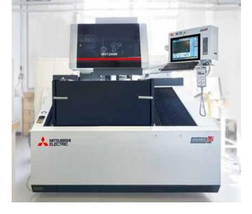
Die bei Boutroué seit 2016 eingesetzte Drahterodiermaschine Mitsubishi Electric MV1200R ermöglicht das automatische Wiedereinfädeln selbst in enge Spalten.
