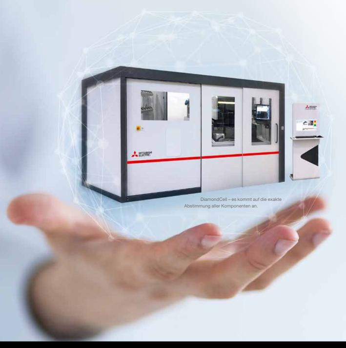
Das "Abrichten" genannte Profilieren und Schärfen von Schleifscheiben durch Funkenerosion ist keine grundsätzlich neue Technologie. Mit den aktuellen Drahterodiermaschinen von Mitsubishi Electric sind die Möglichkeiten der Bearbeitung jedoch erheblich erweitert worden: Anders als beim konventionellen Abrichten mit feststehenden oder beweglichen Abrichtwerkzeugen ist dieser Prozess bei der Drahterosion berührungslos.
