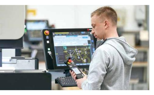
Das frei bewegliche Bediengerät und die Parametrierung am Touchscreen sorgen für kurze Rüstzeiten.
