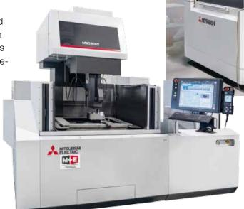
Die neue Drahterodiermaschine MV2400S NewGen wurde Anfang 2019 installiert und arbeitet seitdem ohne Probleme.
