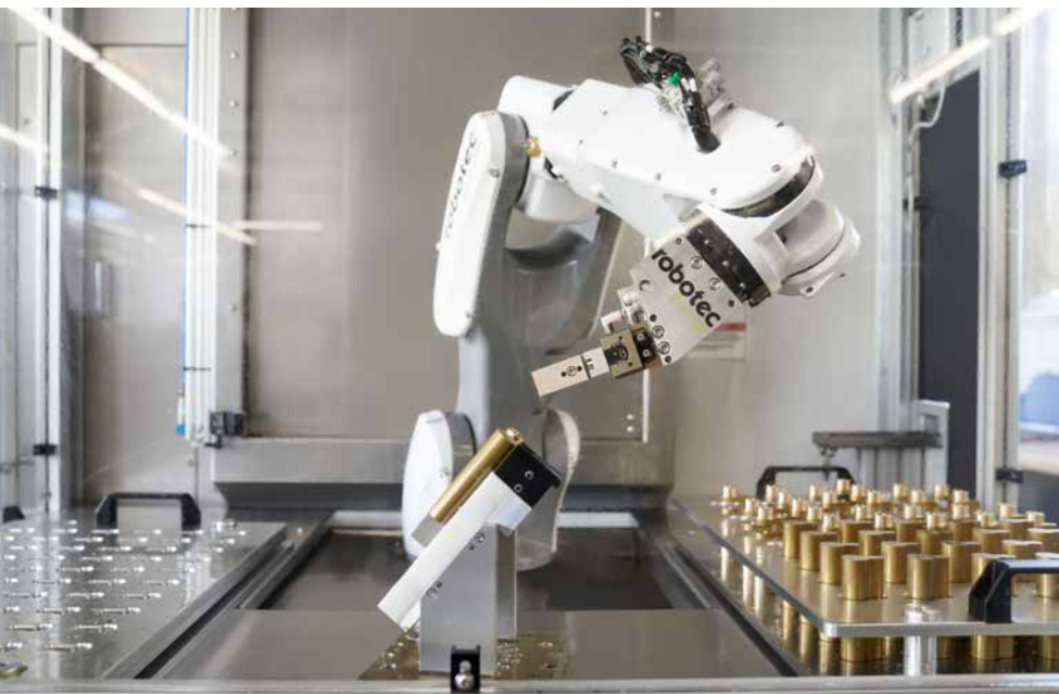
Les serrures à cylindres sont usinées de manière entièrement automatique dans une cellule robotisée.
