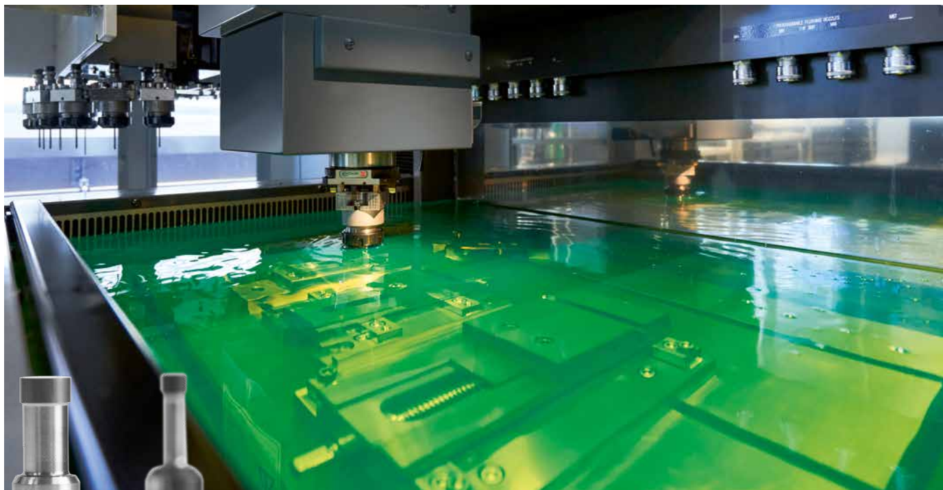
Le système à enfonçage EA12V Avance de Mitsubishi Electric est notamment utilisé pour le fraisage des cônes d'entrée dans les pointes de buse.
