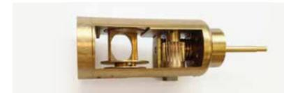
Unten: Rotierender Miniatur-Probenhalter für Messungen bei bis zu 2° Kelvin (-271°C).
