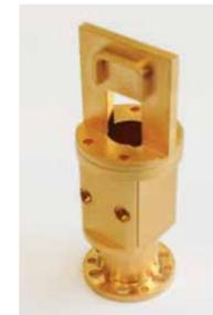
Links: Probenhalter für die Messung physikalischer Eigenschaften von Materialien im Vakuum und bei niedriger Temperatur.
