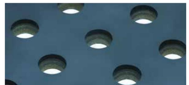
A pesar de su alta densidad de potencia, la tecnología de la serie SG está diseñada para un mecanizado cuidadoso de materiales. Incluso al mecanizar metal duro con corrientes elevadas en operaciones de desbaste, apenas se producen microfisuras. De este modo se prolonga considerablemente la vida útil de los componentes mecanizados.
