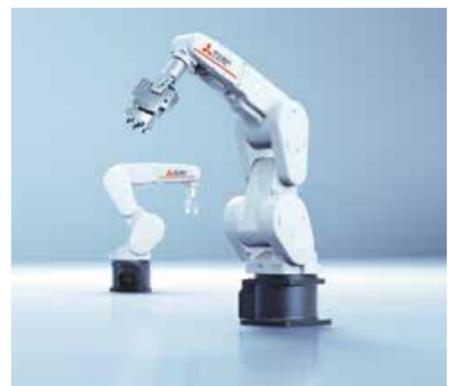
Solución flexible: Robot de brazo articulado de hasta 75 kg de calidad Mitsubishi Electric.
