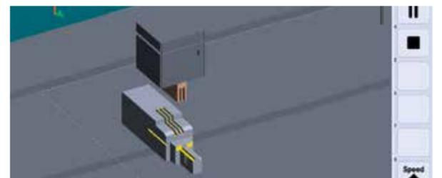
Ampliación de la funcionalidad de programación en el control de la máquina para incluir la verificación del programa de erosión creado utilizando datos 3D importados (Parasolid).
