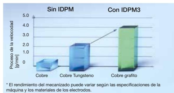
Mejora significativa del erosionado en comparación con las máquinas convencionales: con carburo se puede lograr una velocidad de mecanizado hasta un 40 % mayor, gracias al nuevo IDPM. El uso de grafito infiltrado con cobre aumenta considerablemente el erosionado. El acabado con electrodos de cobre de tungsteno compensa un desgaste ligeramente mayor: rendimiento y precisión combinados. También en carburo.
