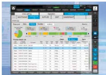
Los datos de funcionamiento y de proceso se pueden consultar en el control. De serie está disponible una función de exportación para todos los datos de proceso, estados operativos, datos de consumo y estados de mantenimiento, así como alarmas. De este modo se pueden visualizar y evaluar los datos de varias máquinas de forma consolidada hasta su integración en sistemas de gestión de producción de nivel superior.
