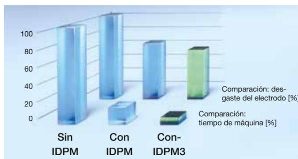
El Power Master IDPM digital guiado por Inteligencia Artificial es la clave para el excelente rendimiento del SG-R. Esta tecnología favorece visiblemente un desgaste mínimo de los electrodos de grafito combinado con altas tasas de erosionado. La formación de nervios profundos con una estructura superficial uniforme es otra característica del nuevo IDPM con IA. El alto rendimiento del IDPM no sólo está disponible para el mecanizado de acero sino también de carburo.
