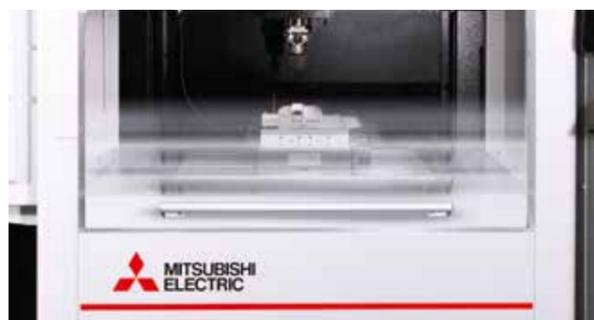
La buena accesibilidad gracias al tanque elevador de tres lados permite una instalación cómoda y rápida. La mesa de trabajo rectificada con precisión ya una altura ergonómica está equipada de serie con ranuras en T. Para la carga con grúa, la carcasa superior se abre fácilmente.
