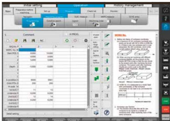
Gracias a los nuevos algoritmos y al uso de la Inteligencia Artificial, ahora se pueden calcular mucho mejor los tiempos de mecanizado por adelantado. El sistema de control "aprende" continuamente durante las distintas operaciones de mecanizado y, por tanto, mejora los tiempos de mecanizado calculados con una precisión cada vez mayor.
