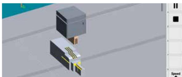
Ampliación de la funcionalidad de programación en el control de la máquina para incluir la verificación del programa de erosión creado utilizando datos 3D importados (Parasolid).
