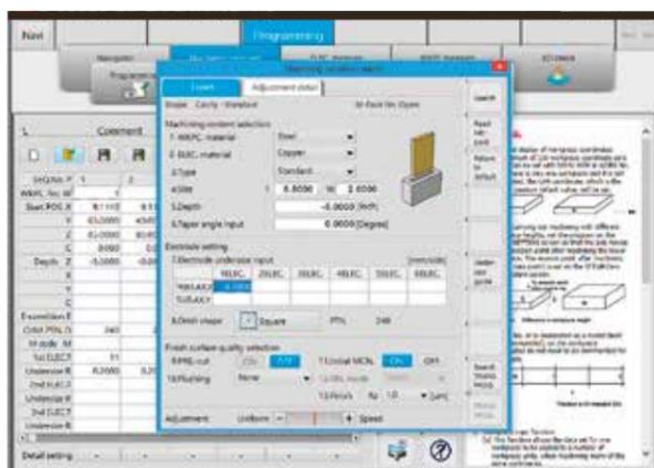
Los programas de mecanizado se crean íntegramente mediante una guía de diálogo; en Mitsubishi Electric esto se llama ESPERADVANCE Navigator. Las ventanas de selección en lenguaje sencillo guían al operador desde la configuración y la selección de tecnología hasta el inicio del programa. Todos los usuarios, desde principiantes hasta profesionales, lo agradecerán.
