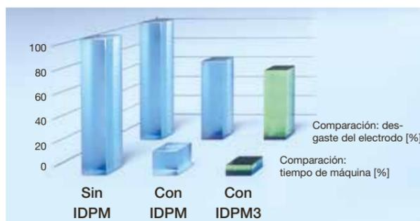
El Power Master IDPM digital guiado por Inteligencia Artificial es la clave para el excelente rendimiento de la SG-S. Esta tecnología favorece visiblemente un desgaste mínimo de los electrodos de grafito combinado con altas tasas de erosión. La formación de nervios profundos con una estructura superficial uniforme es otra característica del nuevo IDPM con IA. El alto rendimiento del IDPM no sólo está disponible para el mecanizado de acero sino también de carburo.
