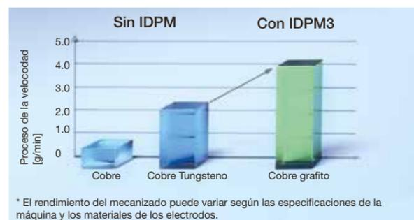
Mejora significativa del erosión en comparación con las máquinas convencionales: con carburo se puede lograr una velocidad de mecanizado hasta un 40 % mayor, gracias al nuevo IDPM. El uso de grafito infiltrado con cobre aumenta considerablemente el erosión. El acabado con electrodos de cobre de tungsteno compensa un desgaste ligeramente mayor: rendimiento y precisión combinados. También en carburo.
