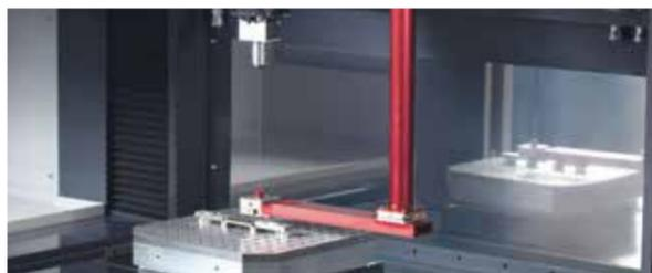
La opción de perforación de agujeros finos permite la producción de agujeros microscópicos precisos en la máquina de electroerosión por penetración. Recomendamos su uso en combinación con una bomba dieléctrica de alta presión.
