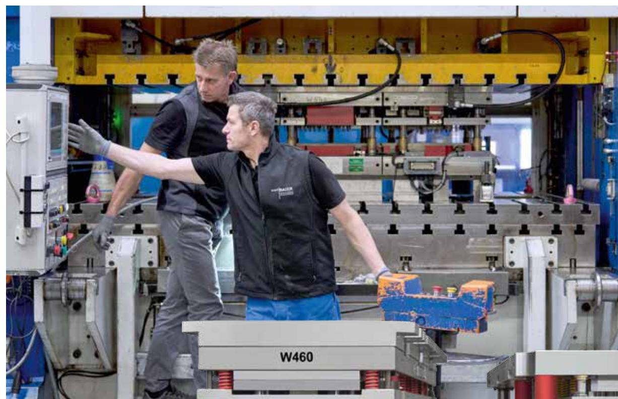
Einstellarbeiten an einem komplexen Folgeverbundwerkzeug
