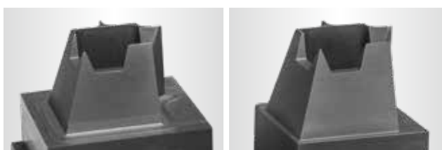
Konvenční eroze: viditelné opotřebení hran
